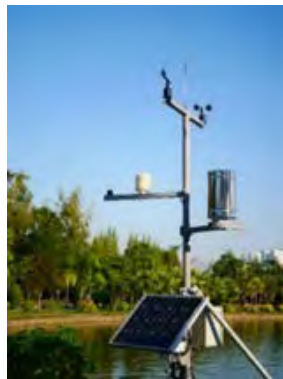
Figura nr.20 Pluviometer me sensor elektronik .
