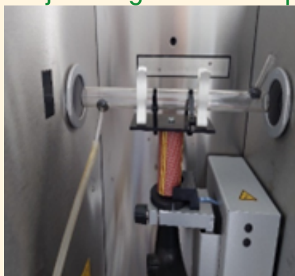
Figura 2 Celula optike me dritare kuarci e përgatitur në laborator
